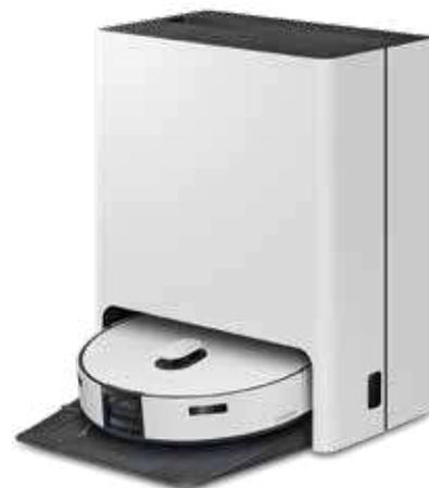
Al termine della sessione di pulizia il robot torna alla Clean Station Steam+ per svuotare la polvere, igienizzare i panni lavapavimenti e asciugarli con un getto di aria calda
